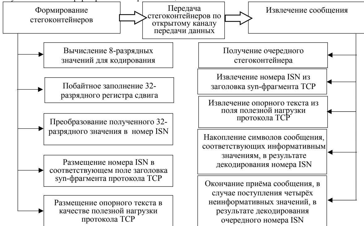
Рис. 1. Структурная схема модели обработки TCP – соединений для стеганографической передачи данных
