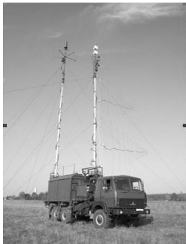
Рис. 4б. Станція перешкод УКХ радіозв'язку "Гроза" у розгорнутому стані
