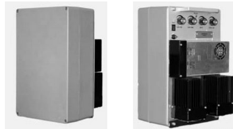
Рис. 5а. Вигляд пристрою блокування роботи телефонів стільникових систем зв’язку “Блокада”
