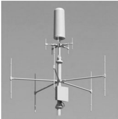
Рис. 4а. Антенна пеленгування станції перешкод УКХ радіозв'язку "Гроза"
