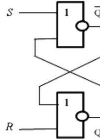
Рис. 1. Схема RS-триггера на элементах ИЛИ-НЕ
