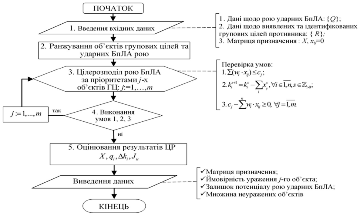
Рисунок 1 – Узагальнена схема алгоритму розв'язання задачі цілерозподілу рою ударних БПЛА по об'єктах групових цілей на основі «узагальненої задачі про мультирюкзак із повтореннями»
