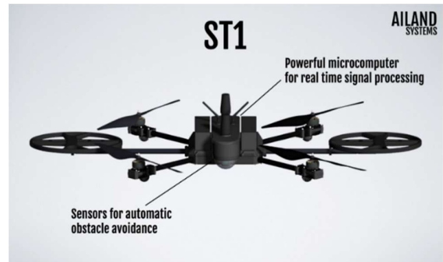
Рисунок 1 – Дрон-детектор мін ST1 для виявлення мін та вибухонебезпечних предметів [5]
