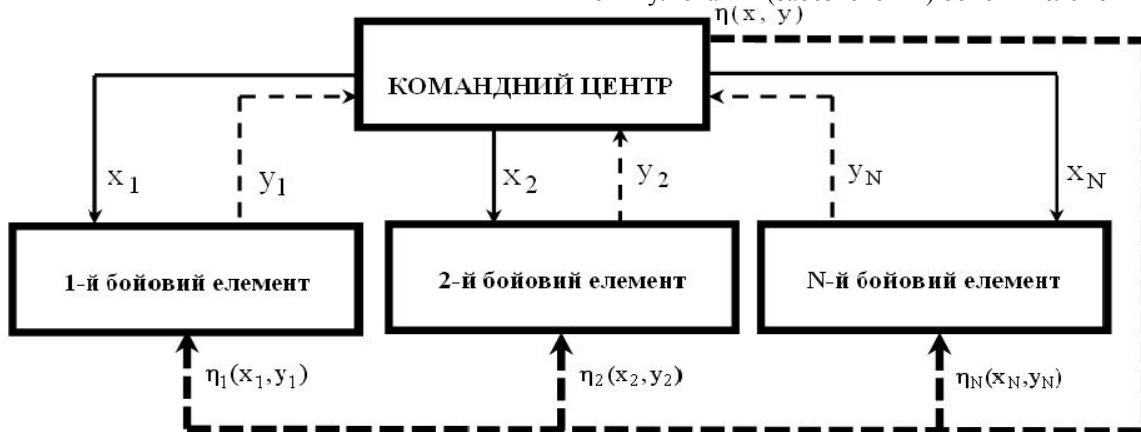
Рис. 1. Взаємодія в активній багатоелементній системі при використанні стимулюючих впливів
