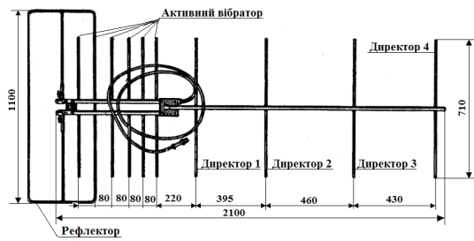
Рис. 1. Антена “хвильвий канал”, що є основним елементом АС РЛС П-18
