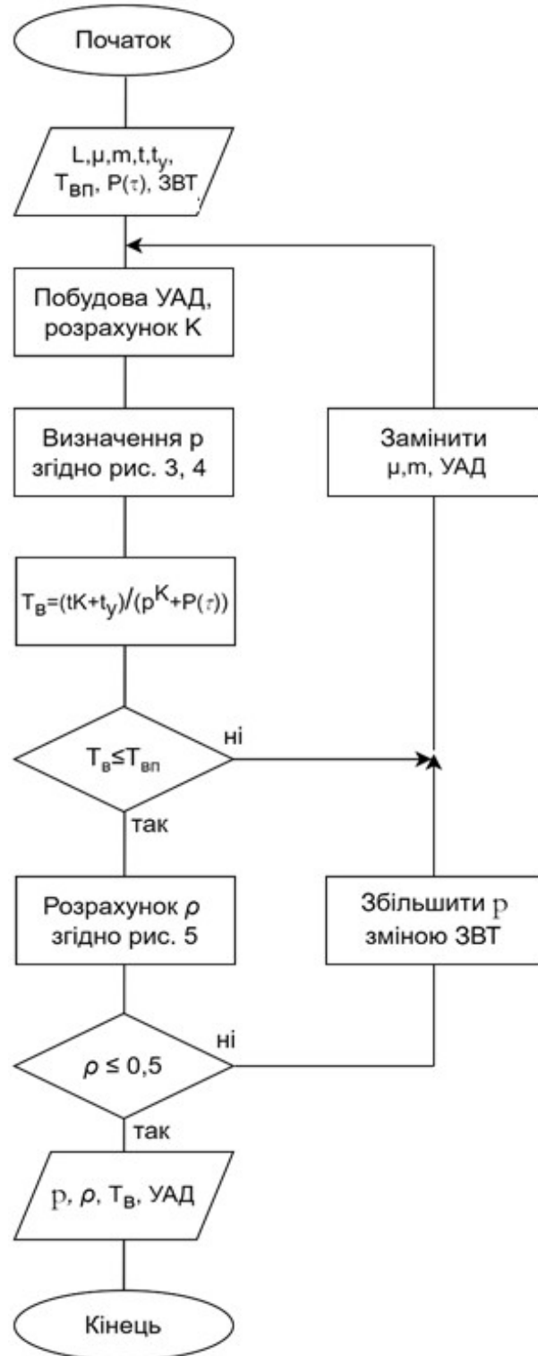
Рисунок 6 – Блок-схема алгоритму перевірки відповідності засобів вимірювальної техніки і умовного алгоритму діагностування вимогам при поточному ремонті радіоелектронних засобів
