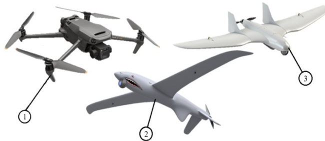
Рисунок 3 – Зовнішній вигляд різних типів безпілотних літальних апаратів: 1 – мультироторного типу; 2, 3 – літакового типу
