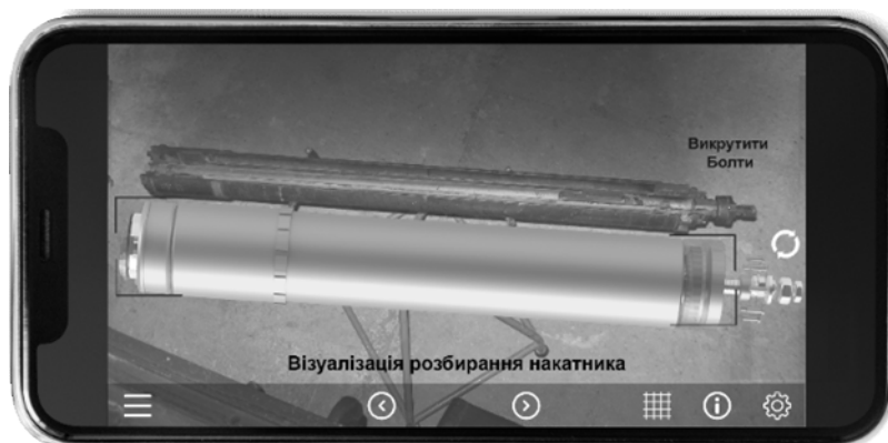
Рисунок 7 – Скріншот візуалізації розбирання накатника 122-мм гаубиці Д-30
