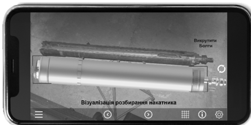
Рисунок 7 – Скріншот візуалізації розбирання накатника 122-мм гаубиці Д-30
