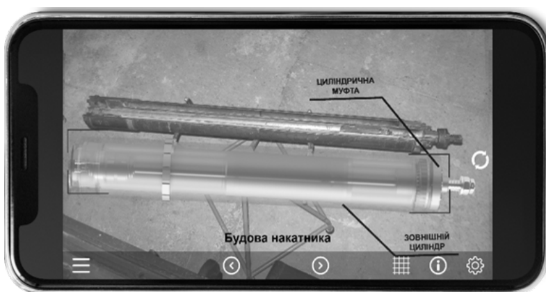
Рисунок 6 – Фрагмент візуалізації будови накатника 122-мм гаубиці Д-30
