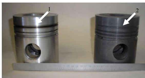
Рис. 2. Загальний вигляд поршнів двигунів внутрішнього згорання: 1 – без обробки; 2 – після вакуумного азотування у пульсуючому пучку плазми
