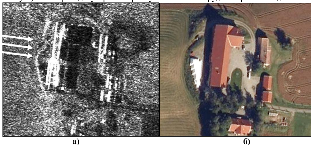
Рис. 12. Зображення будівель з двоскатними дахами: а – радіолокаційний знімок (стрілками вказано напрямок опромінювання EMX PCA); б – оптичне зображення тієї ж ділянки місцевості
