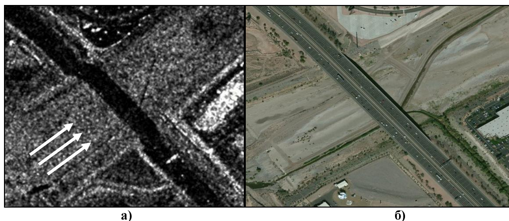
Рис. 9. Спотворення зображення мосту над дифузною поверхнею на радіолокаційному знімку (а) (стрілками вказано напрямок опромінювання ЕМХ РСА); оптичний знімок тієї ж ділянки місцевості (б)
